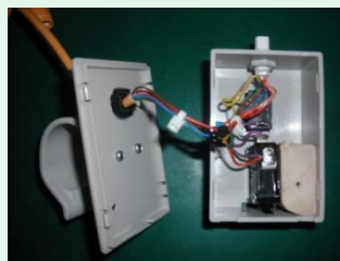
【MEセンターで作成した離床センサー】
