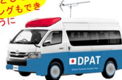
衛星電話やアンテナなど、災害時に必要となる機能を搭載。移動基地として対応できるように、大型のサブバッテリーと、カウンセリングできる簡易面接室も設置。
