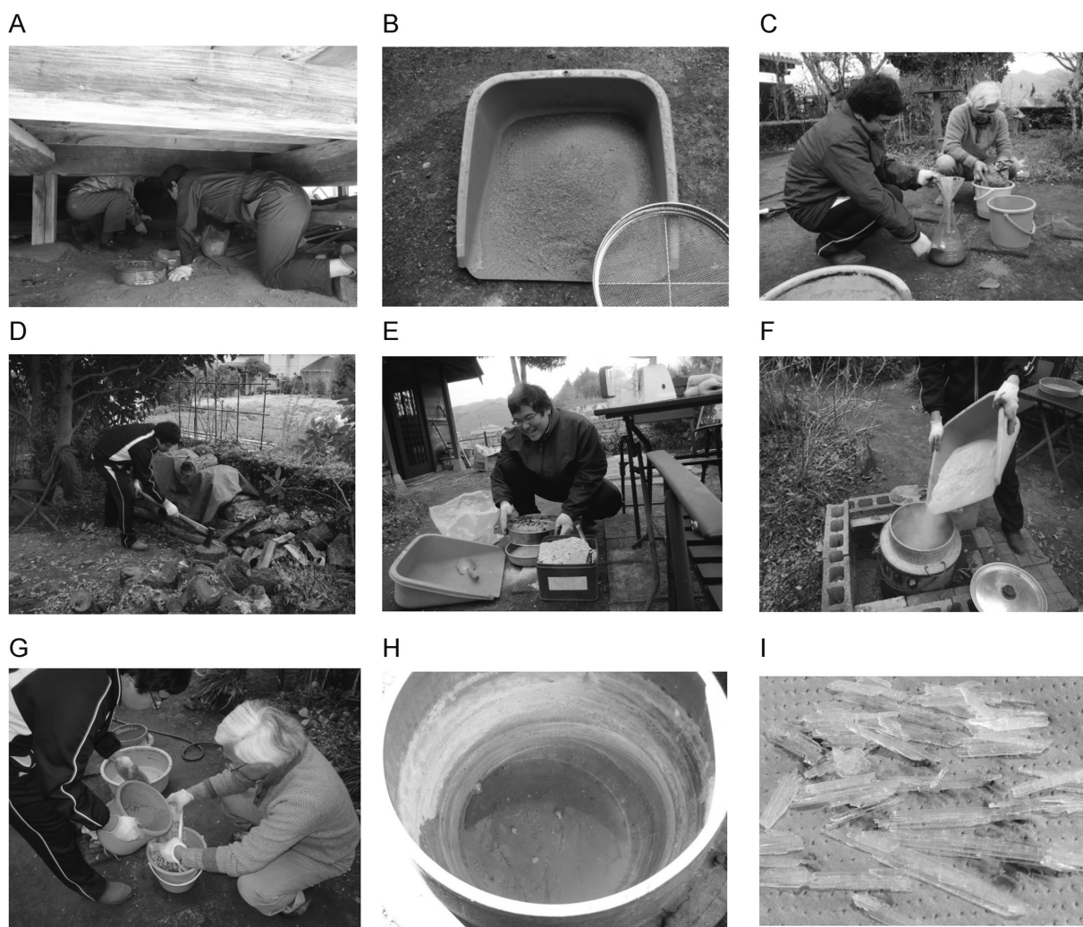
図 2 床下土からの「硝石づくり」の再現実験。写真 A~H は床下土をふるいにかけて、これに水を加えて古文書にある『泥煮』をする様子であり、写真 I は析出した NaNO_3 の結晶を指す。
