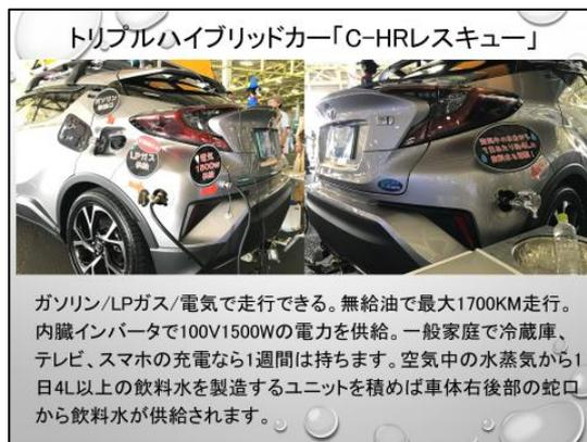
もう一つ、車で電気、ガス、水道を供給できるというものがあります。LP ガスですね。電気もありまして、飲料水も作れるという車になっています。これは、トヨタの C-HR という車を改良してガソリン、LP、電気で行けるそうです。無給油で最大 1,700 キロ走行可能。内蔵インバーターで 100 ボルト、1,500 ワット、だいたい一般家庭の冷蔵庫、テレビ、スマホの充電なら 1 週間くらは使えるということのようです。空気中の水蒸気から 1 日 4 リットルくらいの飲料水を製造できるユニットを積むと、このように蛇口から飲料水が供給されるというような車も、この医療ガスメーカーさんでは持っているそうです。
