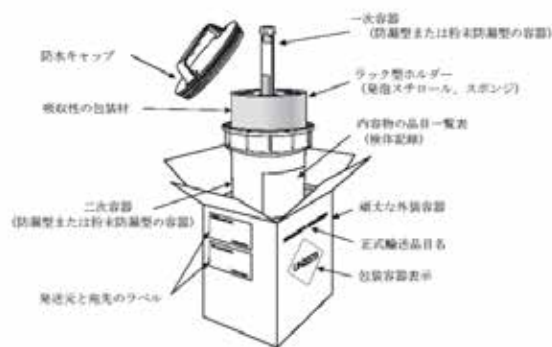
図9：カテゴリーBの感染性物質の三重包装手法の包装容器とラベル貼付の例 (図は IATA [カナダ、モントリオール] の提供)
