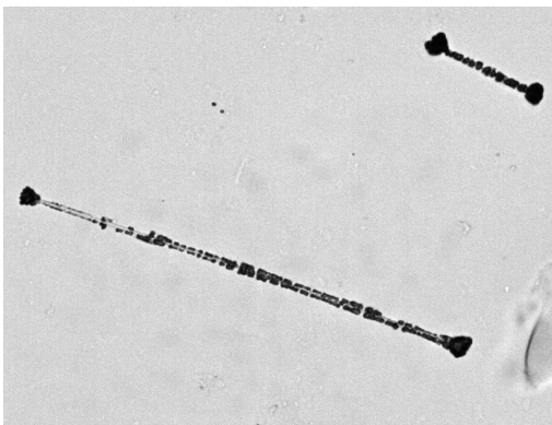
図1 光学顕微鏡で観察された石綿小体像
