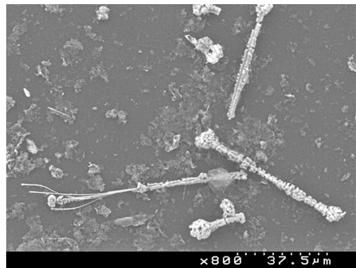
図2 走査型電子顕微鏡で観察された石綿小体と石綿繊維像
