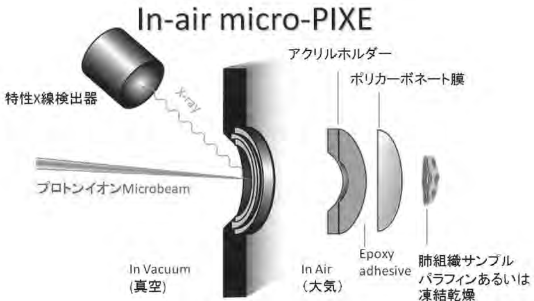
図1 In-air micro-PIXE システムの特性 X 線検出部。試料はパラフィンブロックまたは薄切され高分子のポリカーボネート膜上に載せられる。専用のアクリルホルダーへセットされアクリルホルダーの中心に加速されたプロトンイオンマイクロビームが照射され元素固有の特性 X 線が発生する。この特性 X 線は検出器で検出され元素の組織分布や量が算出される。
