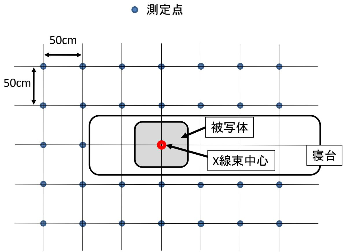
図1 室内散乱X線量の測定点（平面図）
