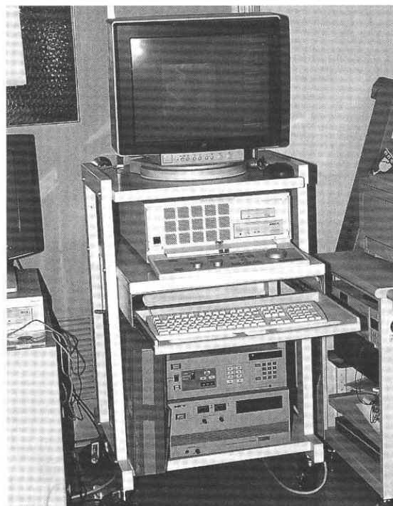
〔写真2〕 DCAP-Iの概観像 (ACC-NEMA DICOM viewing station) ACC DICOMデータが書き込まれたCD-Rの読み出し と、表示観察装置
