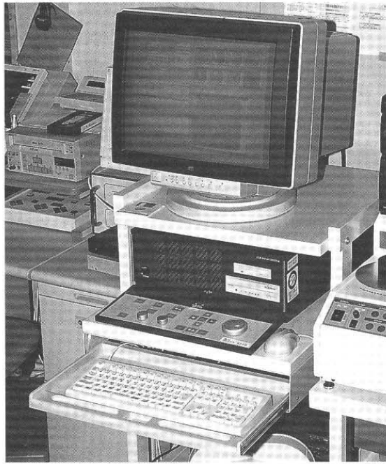
〔写真1〕 CS-2000の概観像 (Real-time video signal to digital DICOM data convert system)
