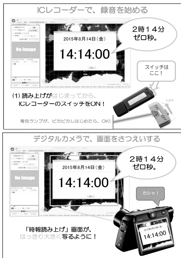
図2 音声・写真の時刻合わせ用情報を記録する手順
