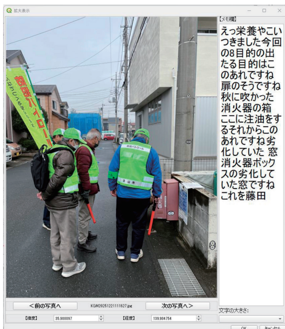
図7 音声自動認識結果を「メモ欄」に表示した例
