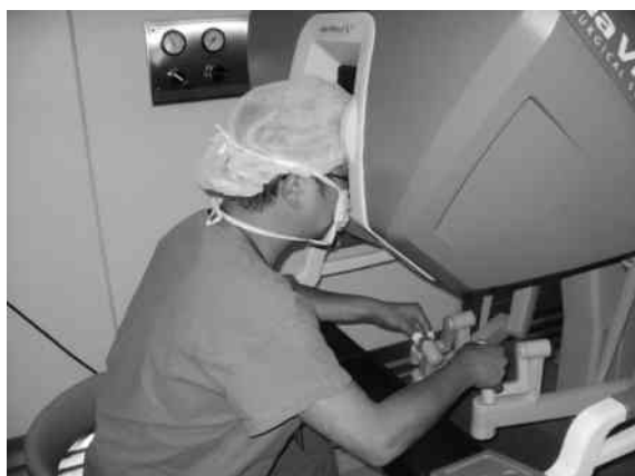
図2 da Vinci® Si™ Surgical System (Intuitive Surgical, Inc.)の Surgeon console 術者は3Dモニターを見ながら、左右2本の指を使ってマスターコントローラー経由で鉗子を操作する。
