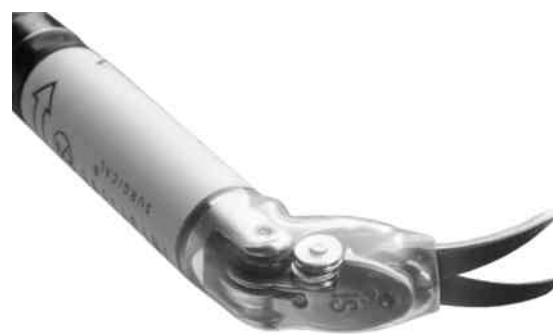
図3 Endo Wrist®インストゥルメント 従来の鏡視下手術鉗子に、手首の屈曲に相当する機能が追加されている。
