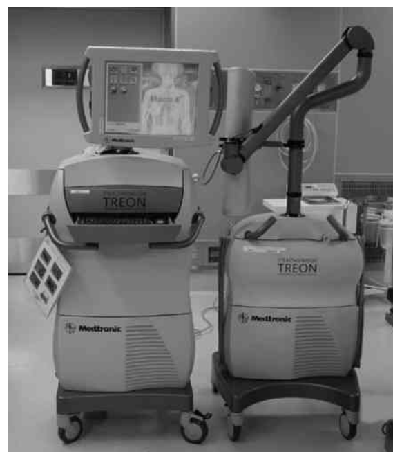
図1 STEALTHSTATION® TREON® plus 左がコンピュータワークステーション, 右がカメラである。
