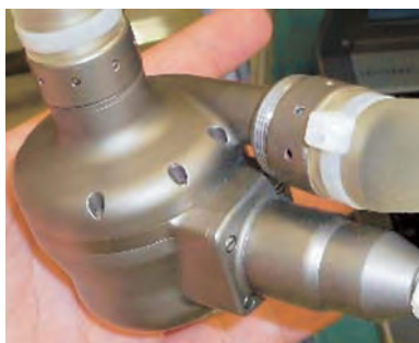
今回植え込まれた手のひらサイズの補助人工心臓
