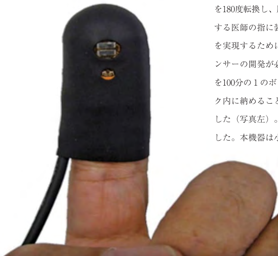
◀指に接着した超小型遠赤外線モニター
