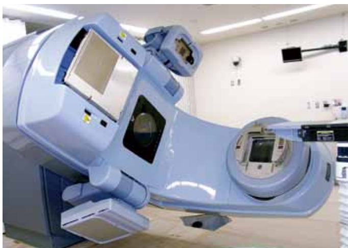
4. 高性能画像誘導装置 ▶ (ブレインラボ社製 EacTrac X-ray) 床のホームベースの様なところからX線が出て、天井から釣り下がっている受像機で撮影をする仕組みとなっている。
