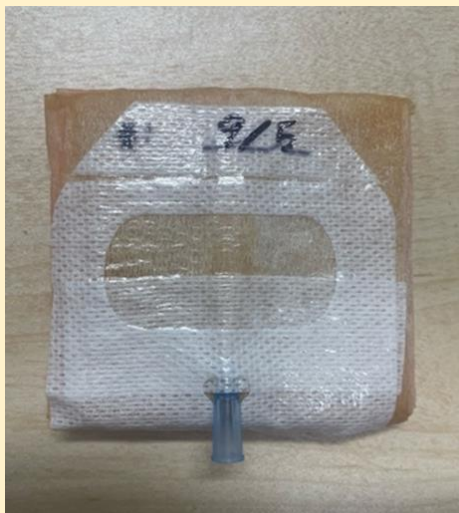
静脈留置カテーテルが抜ける力の計測で使用したファントム
