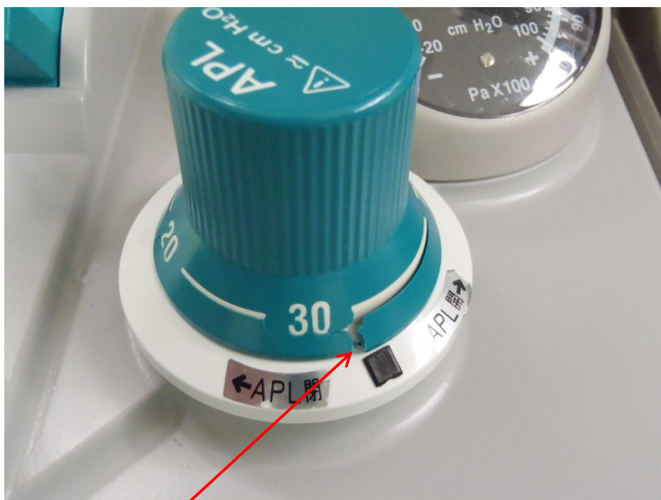
【図5】同じ構造のAestiva/5も同じ亀裂が発生している
