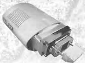
TEM サイドマウントカメラ Veleta にはベルチェ冷却式の CCD チップが搭載されており、2k x 2k メガピクセルと14ビットのダイナミックレンジを実現します。
