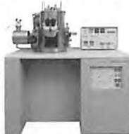
凍結生物試料の細胞や組織の微細構造を冷却したまま高真空中でフリーズフラクチャやフリーズエッチング法などにより、「生体に近い状態」を保持したまま電子ビーム蒸着により超微粒子の金属レプリカ膜を作り、電子顕微鏡観察に適した試料を作ることができます。
