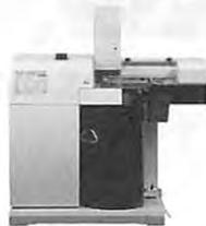
従来の凍結固定法では、約20 $\mu$ mの深さまでしか無氷晶凍結ができませんでしたが、高圧凍結法を使用することで約200 $\mu$ mの深さまで良好な凍結を得ることができます。
