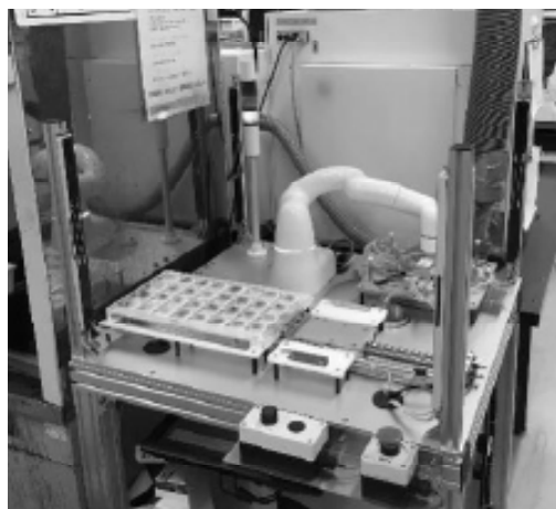
Fig. 3 レベル2に相当する技術で構成されている検体の後加工を実施するロボット
