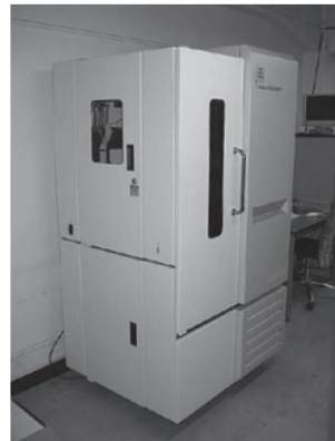
図2 米国 Aushon BioSystems 社製「2470」プロテインマイクロアレイヤー 幅×奥行き×高さ 93×88×181cm。30枚の384穴マイクロプレートおよび100枚のプリント用スライドガラスが一度に搭載可能。マイクロアレイ作製に必須の温度や湿度といった内部環境もコンピュータで制御されている。
