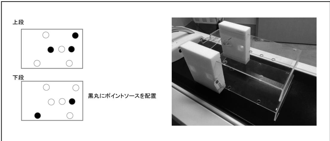
図6.3 メーカー法による線源およびファントムの配置 (SIEMENS)
