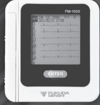
本体寸法:約 W60×H65×D13\* mm \*電池部16.5mm 実寸大
