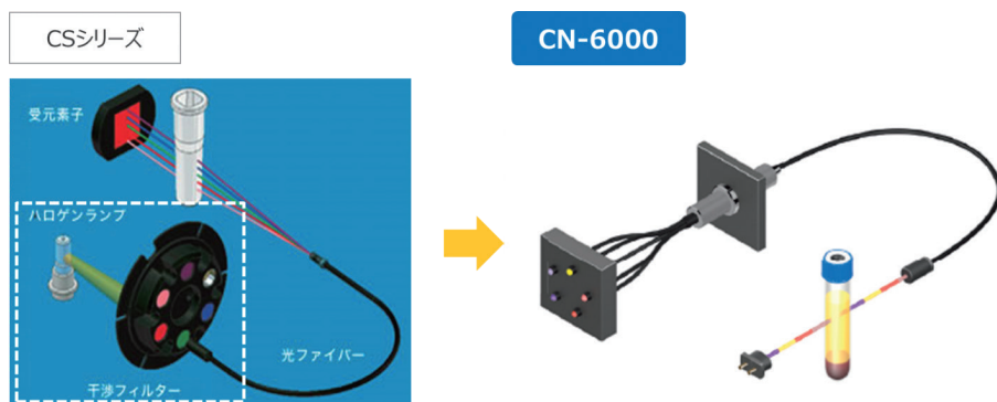
Fig. 2 光源にメンテナンスフリーなLEDを採用 マルチウェーブ検出方式による5波長同時測光機能はそのままに光源にLEDを採用した。 36,000時間の点灯時間を実現でき、従来機器に比べランプ交換の手間とコストが削減できる。
