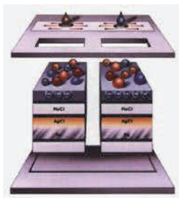
Fig. 3 従来のハロゲンランプ (左) とデジタルリフレクトメーター (右) の測光時のイメージ 従来のハロゲンランプの場合、色が均一化されてしまうが、デジタル画像の場合はスライド上の検体分注位置や細かな反応の変化がピクセル単位で細かく読み取れる。
