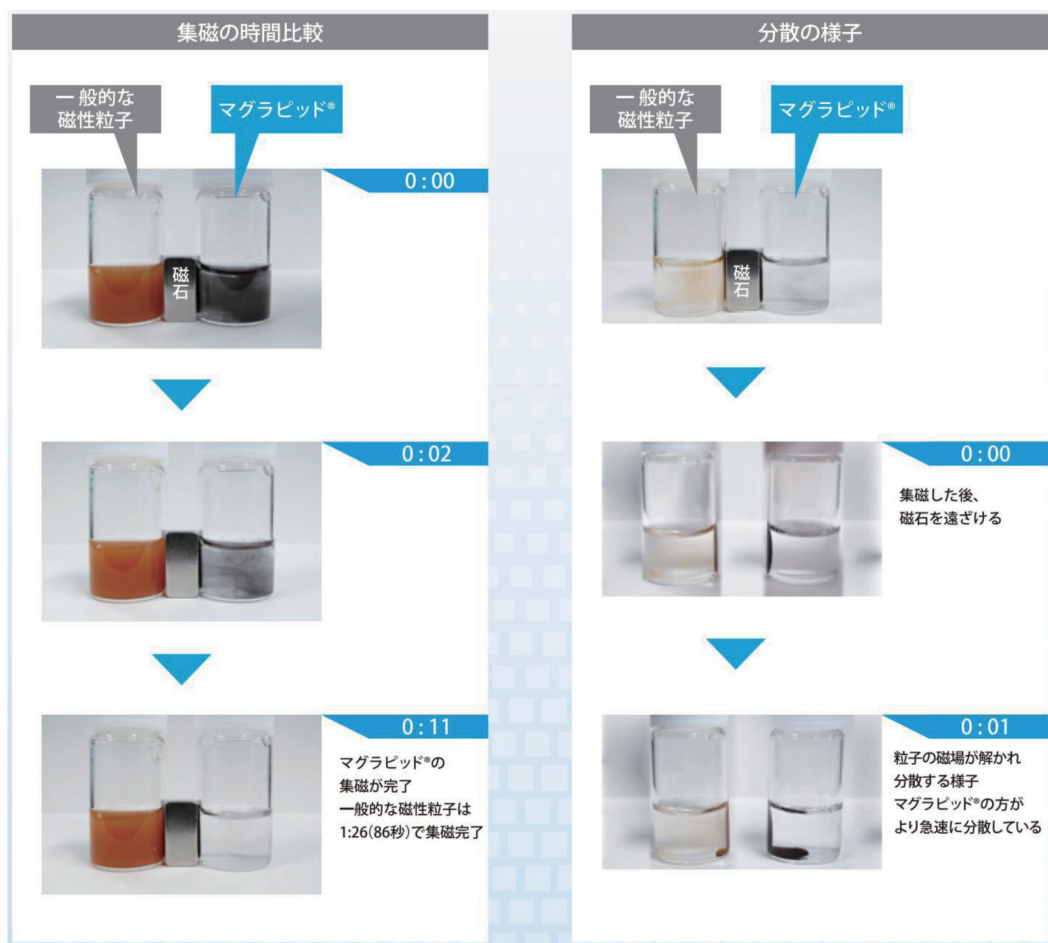
図4 一般的な磁性粒子とマグラピッド®の集磁、分散時間の比較
