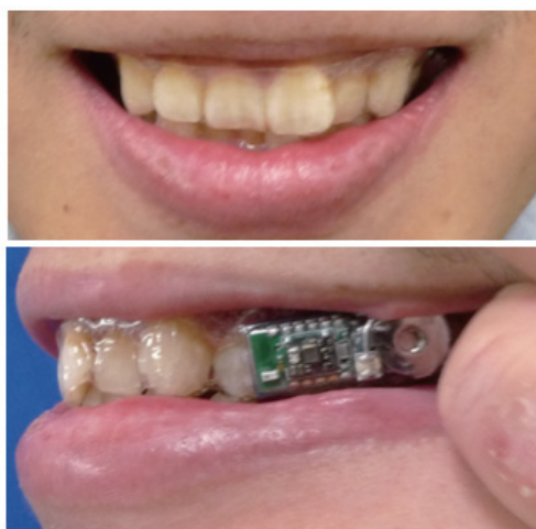
図4. インビジブル (invisible: 不可視) なマウスガード型センサの口腔内への装着写真
