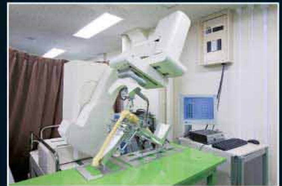
骨を正確にけずる「人工関節置換術支援ロボット」 病気などが原因で膝の関節を人工関節に置き換える際、足の骨を人工関節にあわせて整形する必要がある。人工関節置換術支援ロボットは高速回転する刃物をコンピューターで制御し、計画通り正確に骨をけずることができる。精度の高いけずりだしは、患者の回復の早さにつながる。
