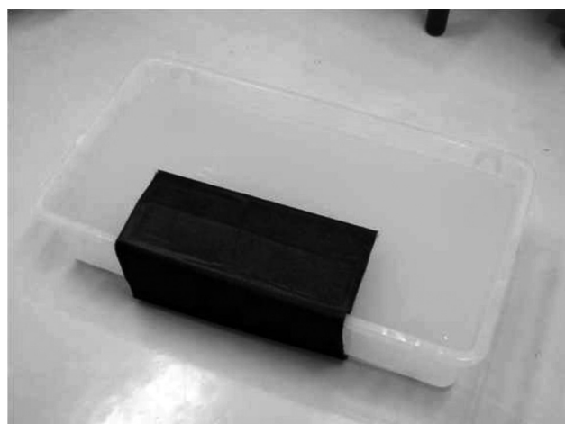
Fig. 12 炭素繊維布によるRFシールド
