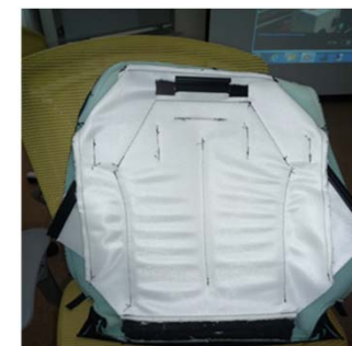
ハンモックをイメージとした張力を利用し、振動を抑制する3Dネット。開発に15年を要した。
