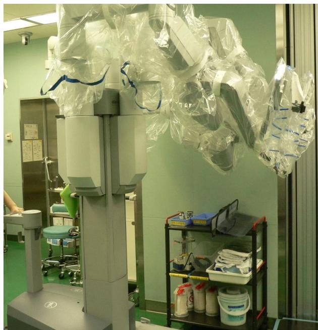
患者にポートが挿入され体位が固定されたらDrからロールインの指示が出るので慎重にゆっくりとペイシェントカートを移動させる。左右、前後の指示が出されるのでそれに従う。
