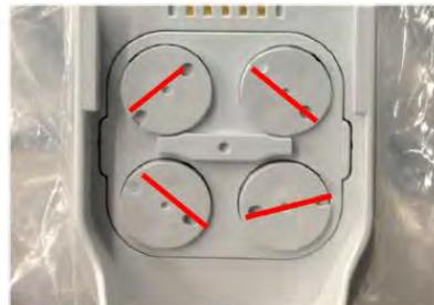
ディスク前面の穴の並びが上の写真のようになっていることを確認する(ダイヤ)
