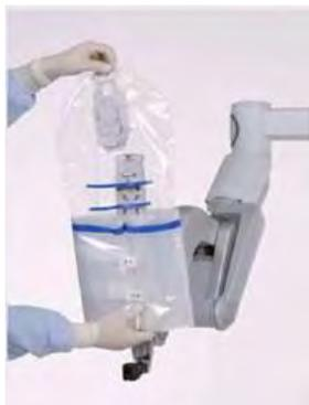
インストゥルメントアダプタの底部をキャリッジにはめ込み、カチッと音がするまでアダプタを押し付けて取り付ける
