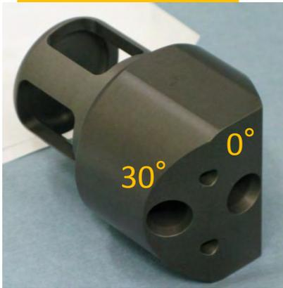
①アライメントターゲットにスコープを挿入する
