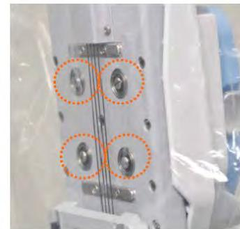
ステリルアダプタの背面にある4つのピンが突出していないことを確認する(フラットな状態でOK)
