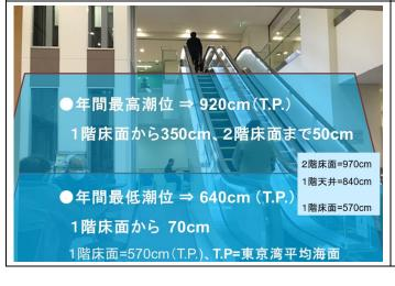
◆スライド。 2階吹き抜けの外来棟の写真で示します。年間最高潮位と最大津波が重なった場合、1階天井を超え、2階床面まで50cm に迫ります。年間最低潮位の時でも1階床面から70cmの津波に襲われます。
